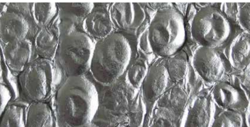
AL-FG-12.7-LG (große Zellen beidseitig geschlossen), Detailausschnitt
