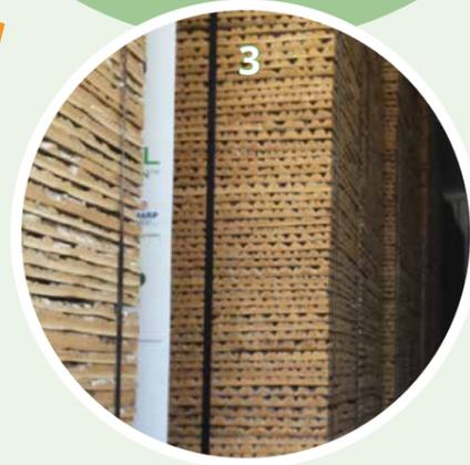
**3** Die behutsam von den Bäumen geschälten Rinden werden zur Produktionsanlage transportiert. Dort werden sie mit hohen Gewichten belegt, in Trockenkammern hitze-sterilisiert und in eine gerade Form gebracht.
